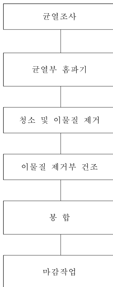
<그림 4.2.14> 교면포장 아스팔트 균열보수
